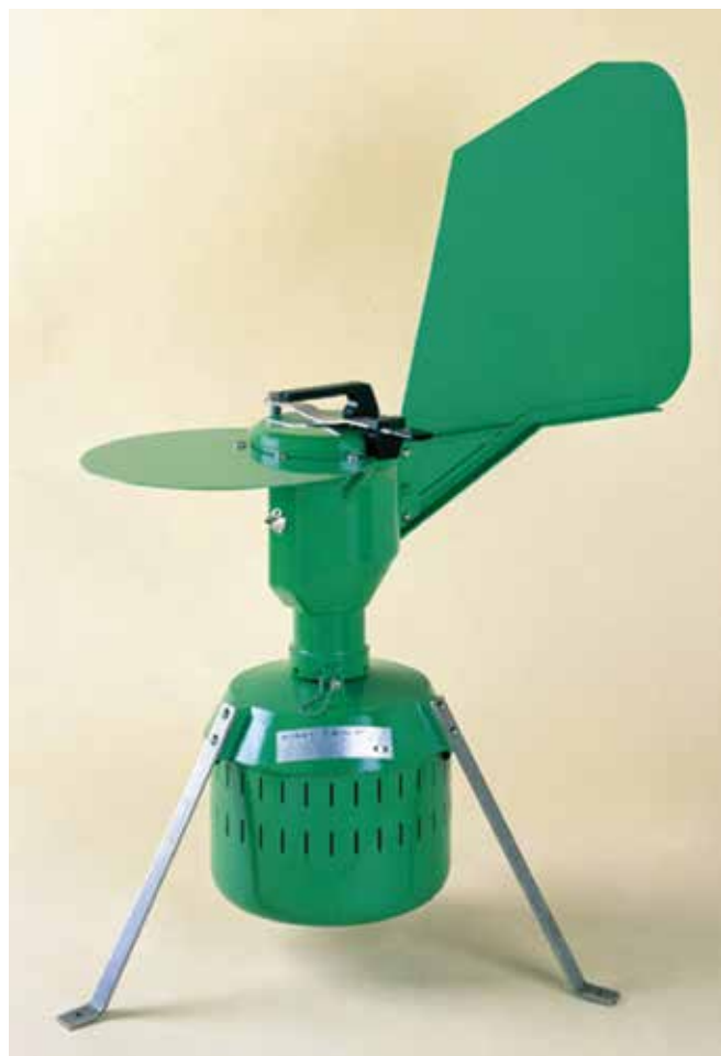
Slika 3-4: Hirstov volumetrični lovilec trosov (Burkard Scientific)
